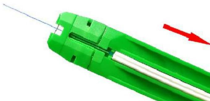
3. Limpiar la fibra óptica con paños de limpieza, colocar la fibra óptica en el cortador y realizar el corte.
