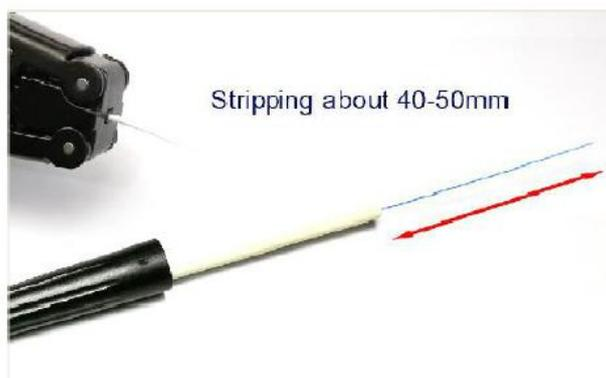
2. Pelar la cubierta o cladding de la fibra óptica. Utilizar el medidor que corresponde a este conector de campo.
